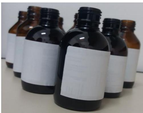
**Figura 7** – Frascos de vidro tipo âmbar 100 ml para teste dos gases com o sensor MQ2
