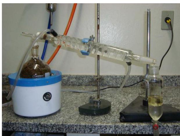
**Figura 2** – Hidrodestilação - Equipamento do tipo Clevenger -
